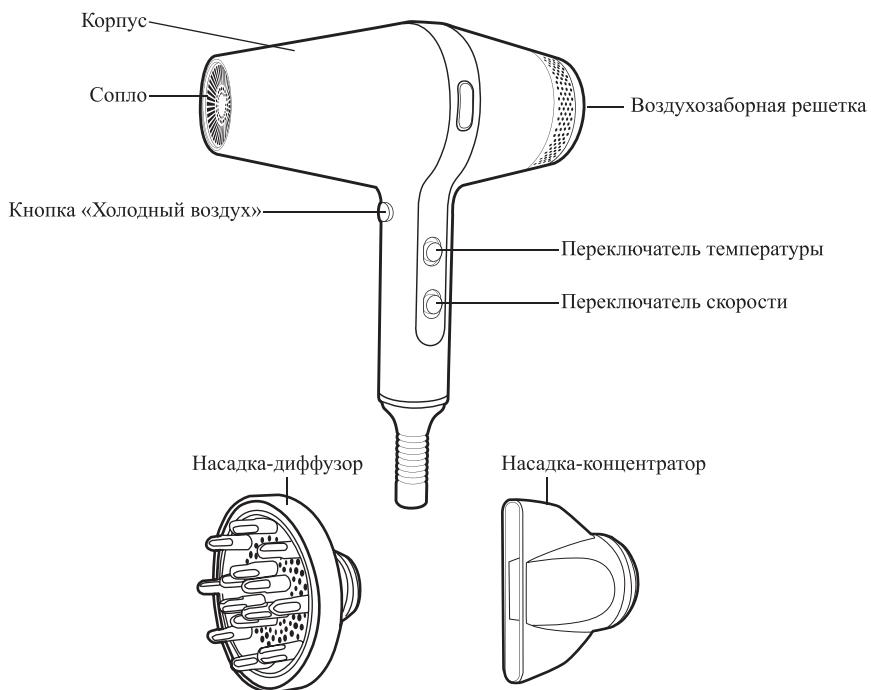
Чтобы включить поток воздуха, переведите **переключатель скорости** вверх в положение «1» (первая скорость работы) или «2» (вторая скорость работы). Чтобы выключить поток воздуха, переведите переключатель вниз в положение «0».
