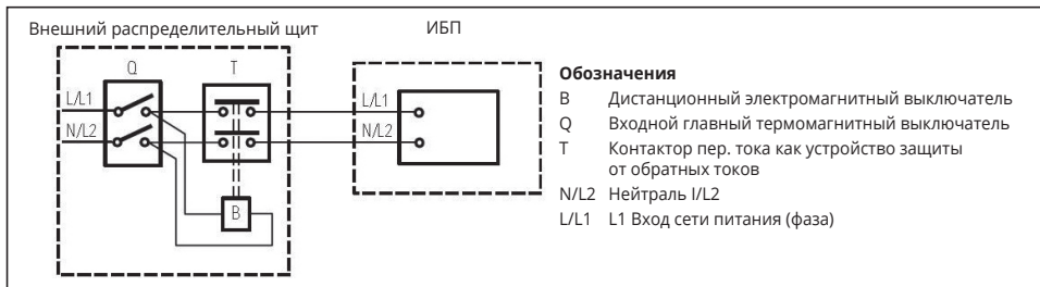
Проводка внешней системы защиты от обратного питания
