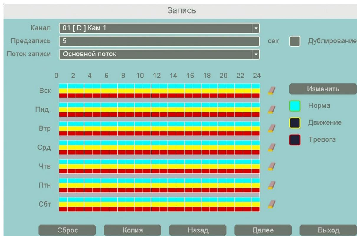
**Поток записи** – запись не только основного видеопотока с камеры, но и субпотока с меньшим разрешением. При включении данной настройки возможно отображение до 16 камер в архиве. **Дублирование** – одновременная запись на два HDD, установленных в регистратор.
