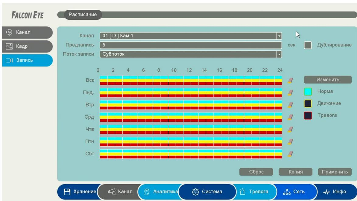
**Поток записи** – запись Основного потока или Субпотока камеры.
