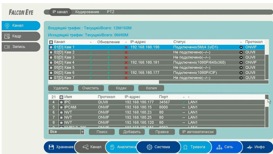
В нижней части экрана находится таблица с найденными камерами, в верхней части экрана находится таблица с подключенными к регистратору камерами.
