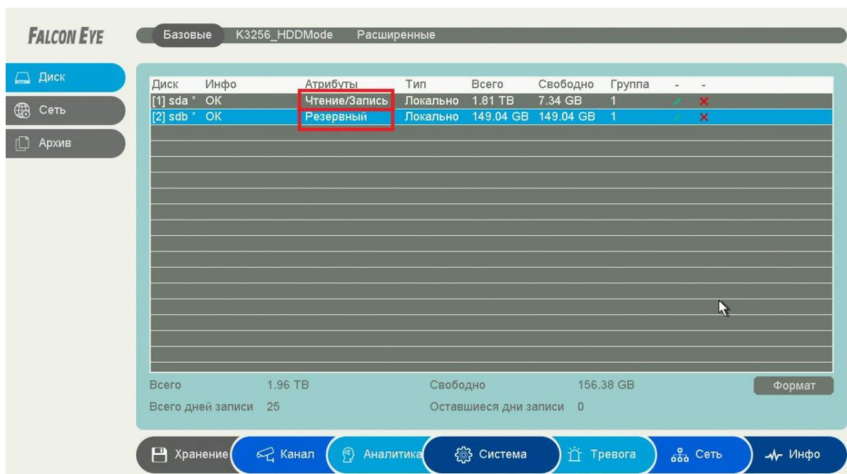
При этом один HDD должен иметь атрибут **Чтение/Запись**, а второй HDD должен иметь атрибут **Резервный**.
