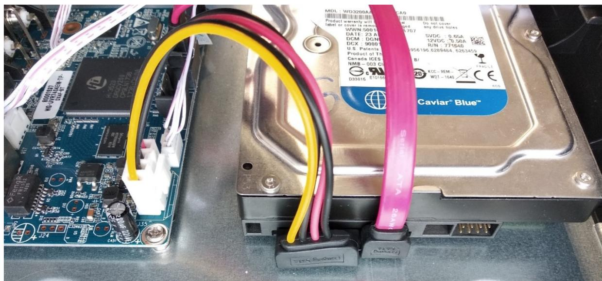
Подключите разъем кабеля питания и SATA кабель к соответствующим разъемам HDD. Установите крышку и закрутите винты. Во избежание повреждения резьбы, не прикладывайте слишком много усилий при затяжке.
