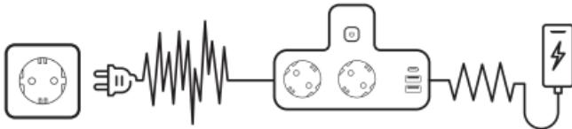
**Сетевой фильтр** – это устройство для защиты электронной техники от сетевых высокочастотных, низкочастотных, импульсных помех, перегрузок по току.
