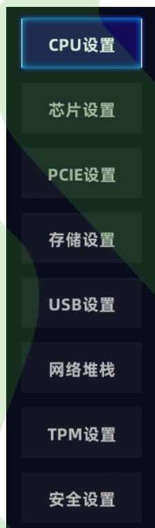
当BIOS选中光标停在主菜单的 [高级] 图标上的时候，使用键盘→键即可进入 [高级] 菜单的子菜单，使用键盘的↑↓键进行子菜单的选择，选中子菜单后再次使用键盘→键即可进入子菜单对应的功能选项区。
