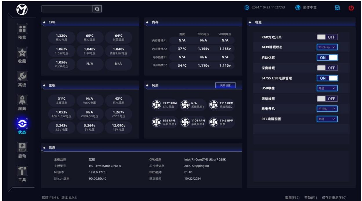
Status (状态) 界面一共分为6个模块，分别为 [CPU电压/温度]、[内存电压/温度]、[主板电压/温度]、[风扇状态]、[主板信息]、[电源选项]。
