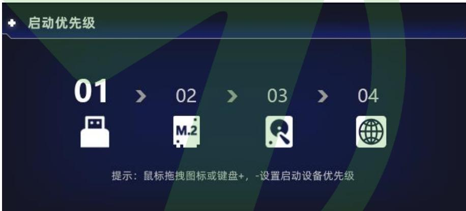
[启动优先级] 模块中，可调整设备第一启动优先级，可使用鼠标点击拖动图标或键盘 +/- 按键操作。
