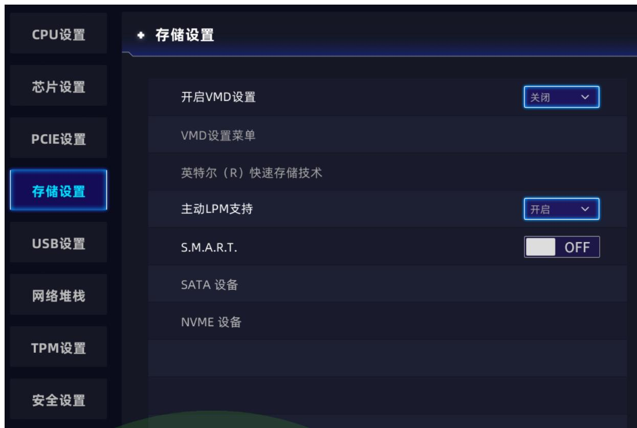
[开启 VMD 设置]：开启/关闭 VMD 设备，开启后可进行 RAID 配置。
