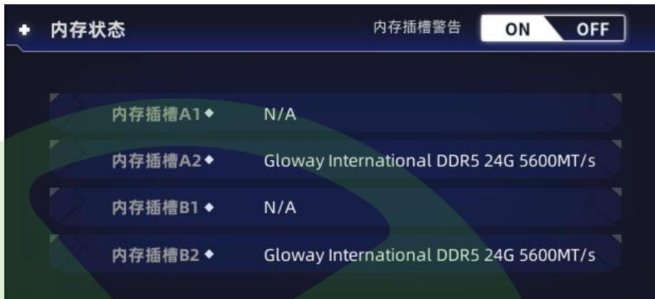
[内存状态] 模块中，可实时显示主板的内存槽上安装了什么内存，安装在什么插槽，并可以读取到简单的内存的SPD信息，界面右上角有[内存插槽警告]功能，开启后，系统在检测到内存没有安装在最佳插槽时，开机会自动进入BIOS并弹出提醒，如下图所示。
