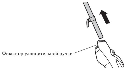
4. Отсоедините напольную щетку, зажав фиксатор напольной щетки на ручном модуле и потянув ручной модуль вверх.
