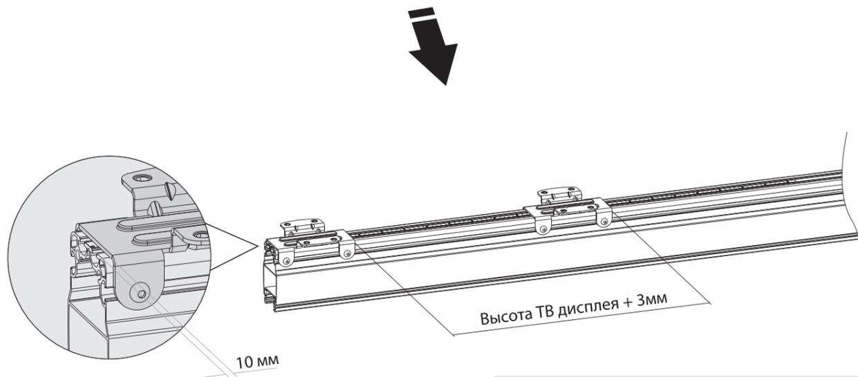
**Примечание:** Расстояние между соединительными пластинами равно высоте экрана плюс дополнительные 3 мм.
