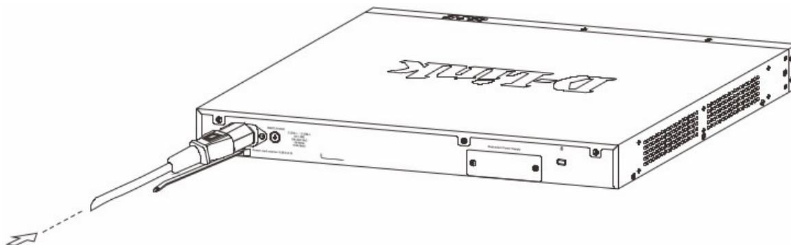
Рисунок 9 — Подключение кабеля питания к коммутатору
