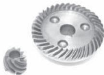
для их создания используется технология термической обработки. Большие и малые зубья подвергнуты вакуумной закалке, что делает шестерни высокого уровня твердости. Благодаря этому осуществляется передача большой энергии, увеличивается эффективность и срок эксплуатации.
