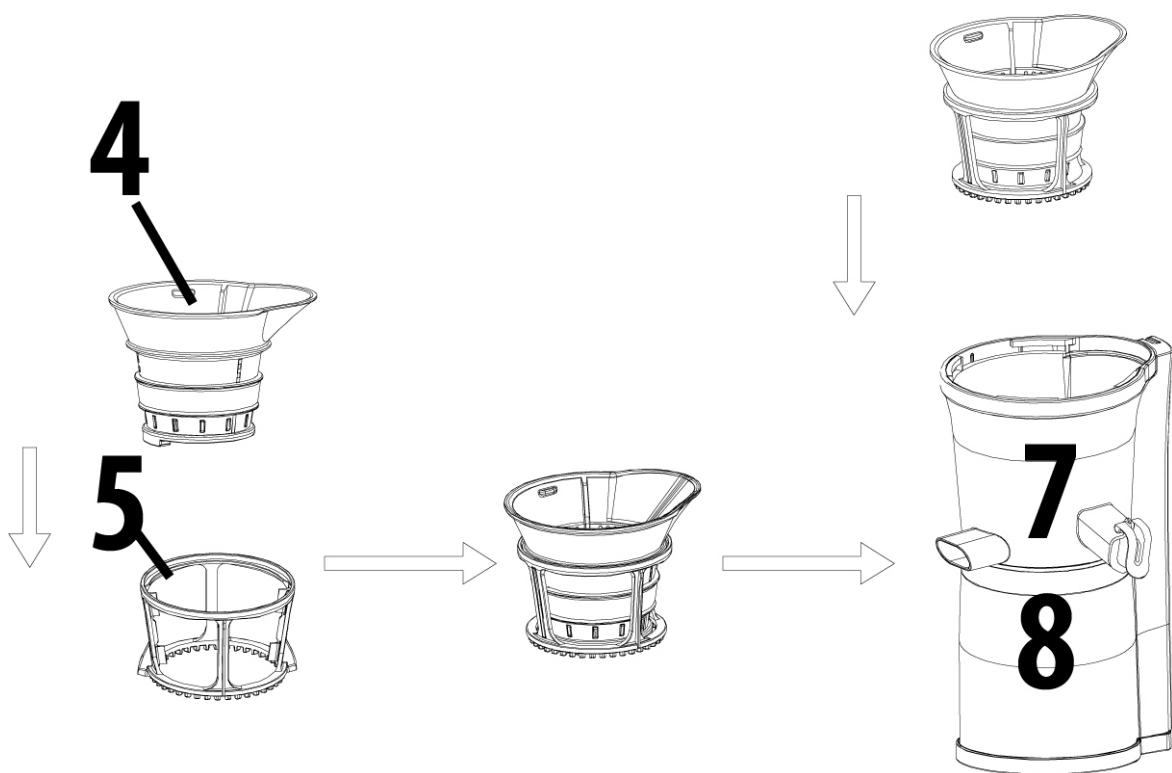
**Per l'estrazione di succo:** Inserire il filtro per spremuta (4) nel telaio portafiltro (5) e ruotare leggermente fino all'arresto. Sistemare il filtro per spremuta con il telaio portafiltro nel vano filtro (7).
