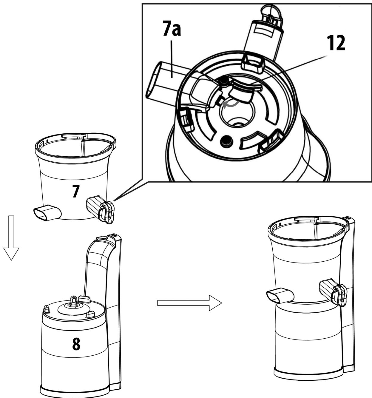
Asegúrese de que el tapón de silicona (12) está colocado en la salida para la pulpa (7a); véase la parte inferior del compartimento de tamiz con las salidas (7). Posicione el compartimento de tamiz con las salidas (7) en el bloque de motor (8).
