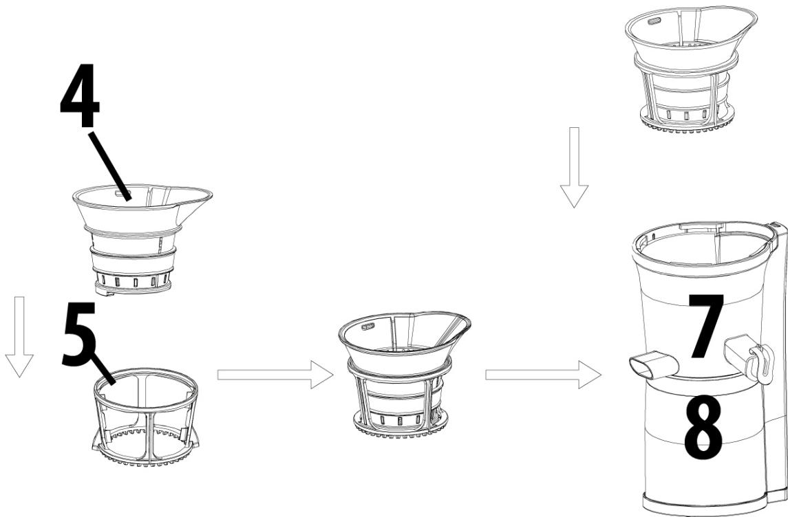
**Für das Entsaften:** Saftsieb (4) in Siebrahmen (5) stecken und leicht drehen, bis der Siebrahmen einrastet.
