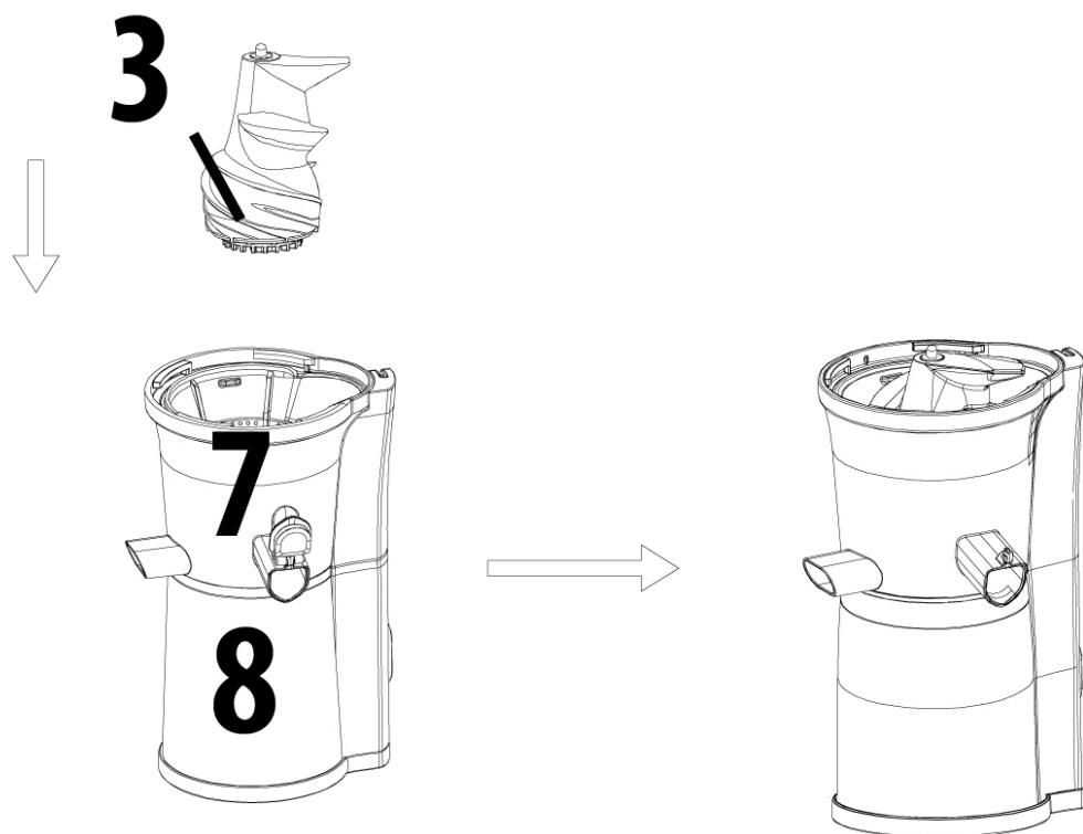
A continuación, coloque la rosca transportadora (3) en el tamiz de zumo/accesorio para sorbete ya instalado y presiónela hacia abajo hasta que encaje.
