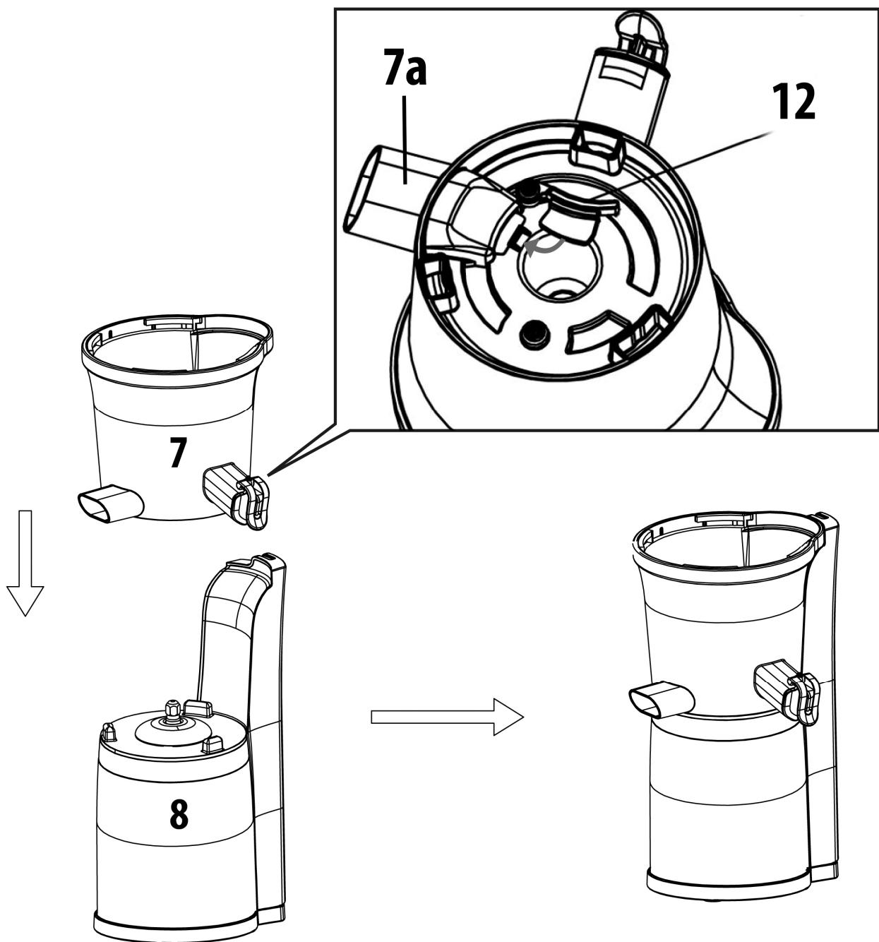
Assurez-vous que le bouchon en silicone (12) est placé dans la sortie pour la pulpe (7a), voir le dessous du compartiment à tamis avec sorties (7). Placer le compartiment à tamis avec les sorties (7) sur le bloc-moteur (8).
