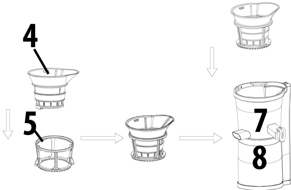
**Pour la extraction de jus :** Insérer le tamis à jus (4) dans le cadre du tamis (5) et le tourner légèrement jusqu'à ce que le cadre du tamis s'enclenche. Placer ensuite le compartiment à tamis à jus avec le cadre de tamis dans le compartiment de tamisage (7).
