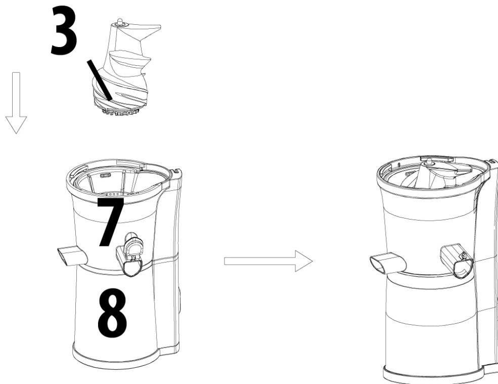
Dann die Beförderungsschnecke (3) im bereits eingebauten Saftsieb / Sorbeteinsatz platzieren, herab drücken und drehen bis diese einrastet.
