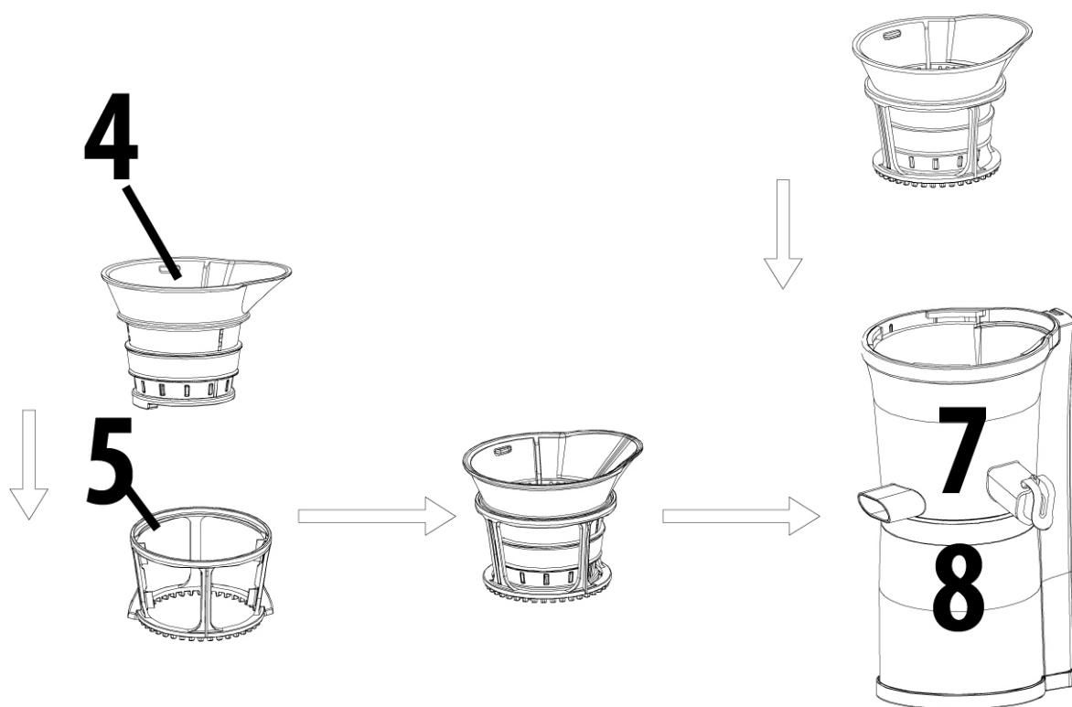
**Para espremer:** insira a peneira de sumo (4) na estrutura da peneira (5) e rode ligeiramente até a estrutura da peneira engatar. A seguir, coloque a peneira de sumo com a estrutura da peneira no elemento da peneira (7).
