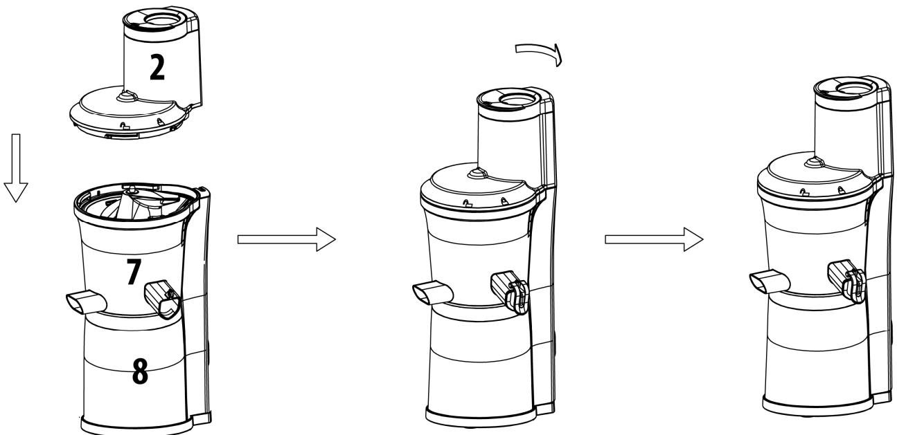
Поместите загрузочную трубу (2) таким образом, чтобы символ на трубе оказался над символом на средней части Отсек для сита (7). Нажмите и поверните по часовой стрелке таким образом, чтобы символ на загрузочной трубе (2) оказался над символом на средней части Отсек для сита (7).
