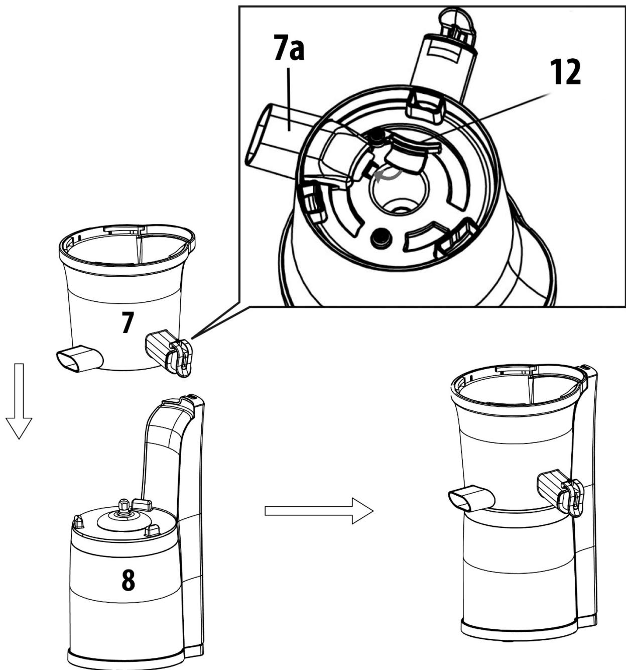
Säkerställ att silikonpluggen (12) i behållaren för pressrester (7a), se undersida silfack med utlopp (7). Placera silfacket med utlopp (7) på motorblocket (8).
