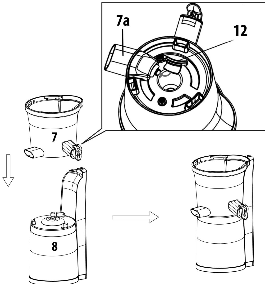
Certifique-se de que o tampão de silicone (12) está colocado na saída para restos (7a), ver face inferior do elemento da peneira com saídas (7).
