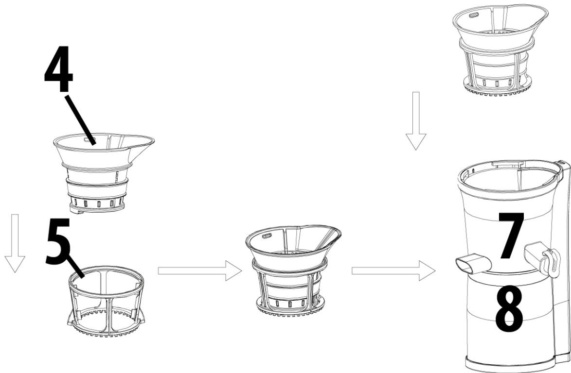
**Voor het juisen:** Steek de sapzeef (4) in het zeefframe (5) en draai hem licht, totdat het zeefframe vastklikt. Doe dan de sapzeef met het zeefframe in het zeefvak (7).
