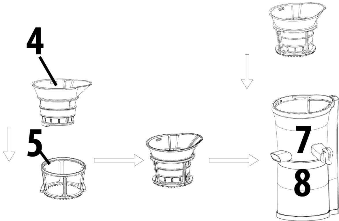
**Para exprimir zumo:** Coloque el tamiz de zumo (4) en el portatamiz (5) y gírelo ligeramente hasta que el portatamiz encaje. Seguidamente, coloque el tamiz de zumo con el portatamiz en el compartimento de tamiz (7).
