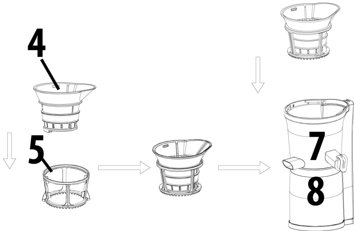
**Для приготовления сока:** Сито для сока (4) вставьте в раму сита (5) и немного поверните, пока рама сита не зафиксируется. Потом сито для сока вместе с рамой сита вставьте в отсек для сита (7).
