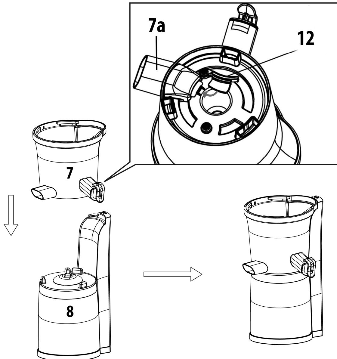
Stellen Sie sicher, dass der Silikonpropfen (12) im Auslauf für den Trester (7a) platziert ist, siehe Unterseite Siebfach mit Ausläufen (7).
