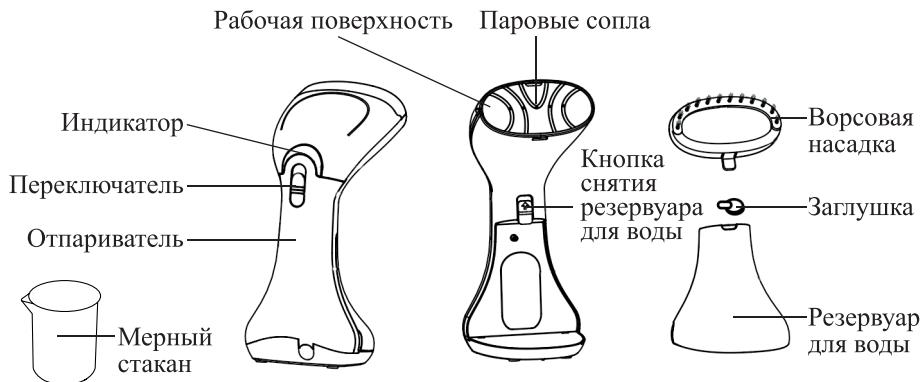
Отпариватель оснащен помпой (водяным насосом). Вода из резервуара подкачивается помпой и по шлангу передается к бойлеру, где испаряется. Пар выходит через паровые сопла на рабочей поверхности. Помпа позволяет точно дозировать количество подаваемой в бойлер воды и получать устойчивую подачу пара.
