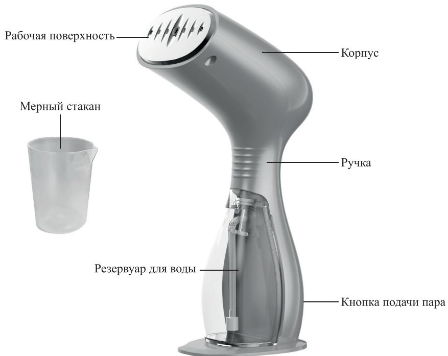
Отпариватель оснащен помпой (водяным насосом). Вода из резервуара подается помпой в бойлер, где испаряется. Пар выходит через отверстия на рабочей поверхности. Помпа позволяет точно дозировать количество подаваемой в бойлер воды и получать устойчивую подачу пара.
