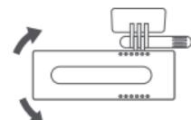
Отрегулируйте угол камеры на основе изображения на главном экране видеорегистратора.
