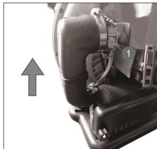
Рис. 10 Воздушная заслонка карбюратора закрыта
