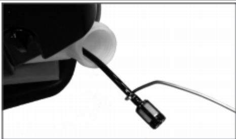
Рис. 15 Извлечение топливного фильтра
