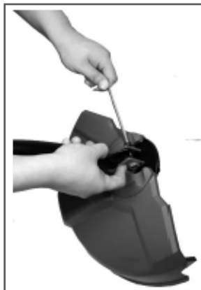
Рис. 3 Установка защитного кожуха
