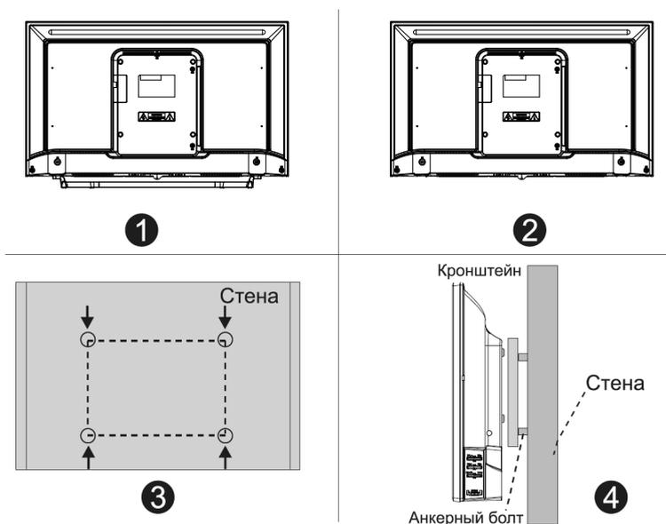
1. Положите телевизор экраном вниз на мягкую поверхность, чтобы предотвратить его повреждение.
