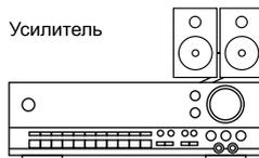
Только для ЦТВ или HDMI источника сигнала. Подключите коаксиальный вход внешней аудиосистемы к соответствующему выходу телевизора. Коаксиальный выход телевизора обеспечит вам наиболее качественную передачу звука на внешнюю аудиосистему без искажений.
