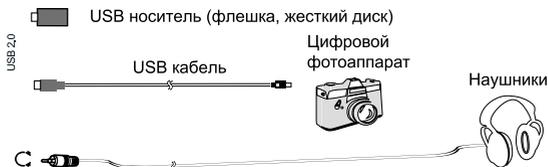
Разъем для подключения USB-устройства телевизора становится активным только в режиме USB.
