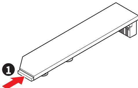
2. Приподнимите край радиатора Screwless M.2 Shield Frozr и сдвиньте его вперед, чтобы снять радиатор.
