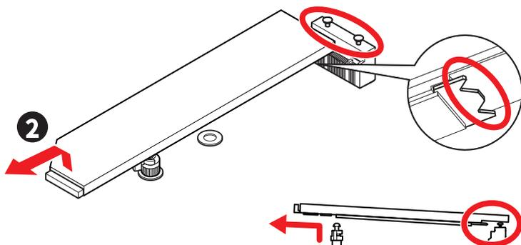
3. Вставьте **зажим EZ M.2 II** в отверстия под винт, затем используйте **инструмент для снятия зажима EZ M.2 II** и закрутите его по часовой стрелке, чтобы закрепить зажим. Пропустите этот шаг при установке 2280 SSD.
