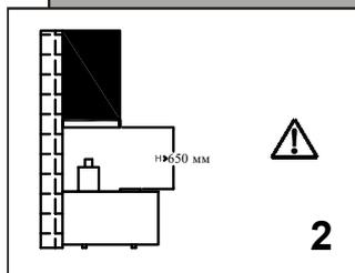
Мы рекомендуем, чтобы после установки нижняя часть вытяжки находилась на расстоянии не менее 650 мм и не более 750 мм над нагревательными элементами варочной панели
