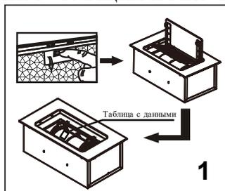
Проверьте напряжение и частоту, указанные на табличке с данными, расположенной внутри вытяжки.
