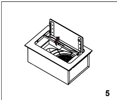
Извлеките жироулавливающий фильтр, открутите 4 винта фиксирующей панели и снимите ее.
