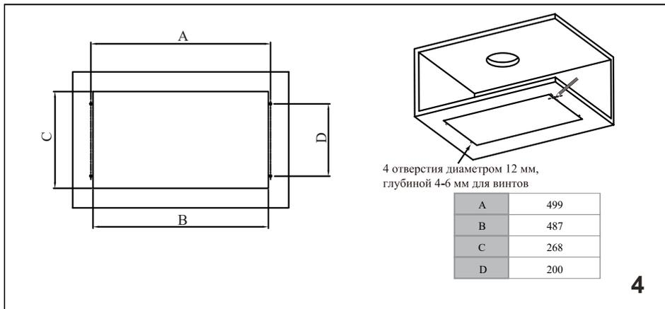
Отметьте размеры выреза в зависимости от габаритов вашей вытяжки.
