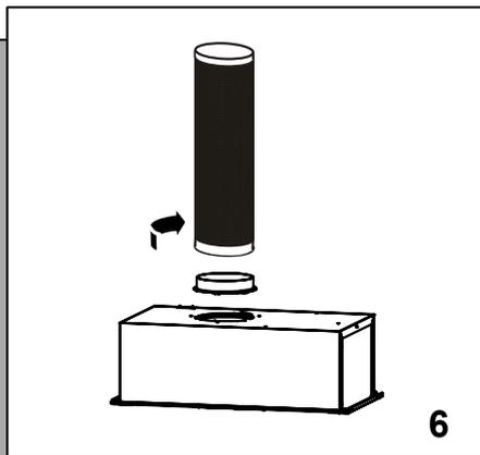
Подключите вытяжной трубопровод к адаптеру воздуховода и установите его на вытяжку в соответствии с указанными инструкциями.
