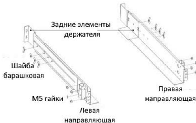
Рисунок 2-4. Крепление монтажного комплекта рельс
