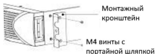
Рисунок 2-6. Установка монтажных кронштейнов
