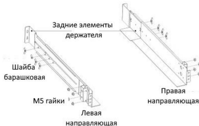
Рисунок 2-4. Крепление монтажного комплекта рельс
