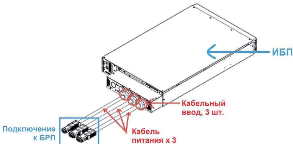
*Рисунок 7-18. Предустановленные кабели питания и кабельные вводы*
