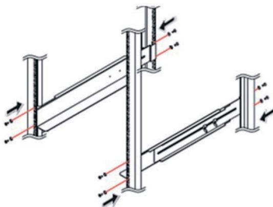
**Рисунок 6-3. Фиксация направляющих на стойке**
