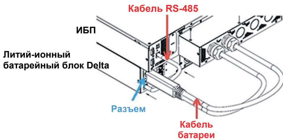
*Рисунок 8-4. Подключение ИБП к литий-ионному батарейному блоку Delta*
