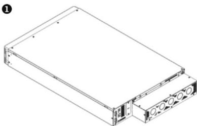
Вид ИБП сзади с оригинальной задней панелью для подключения свинцово-кислотных батарейных блоков Delta.
