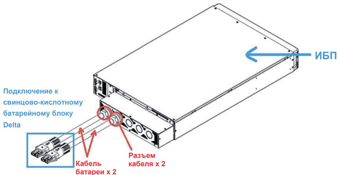
**Рисунок 8-1. Предустановленные кабели батареи и разъемы кабелей**
