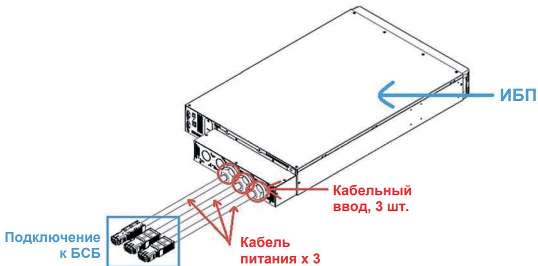
**Рисунок 7-16. Предустановленные кабели питания и кабельные вводы**
