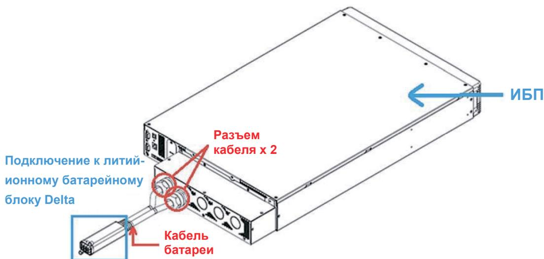
*Рисунок 8-3. Предустановленный кабель батареи и разъемы кабелей*
