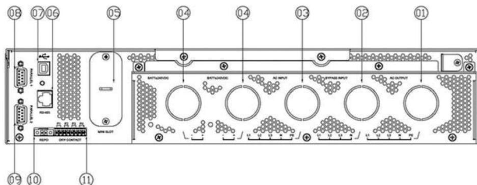
Рисунок 4-1. Задняя панель ИБП
