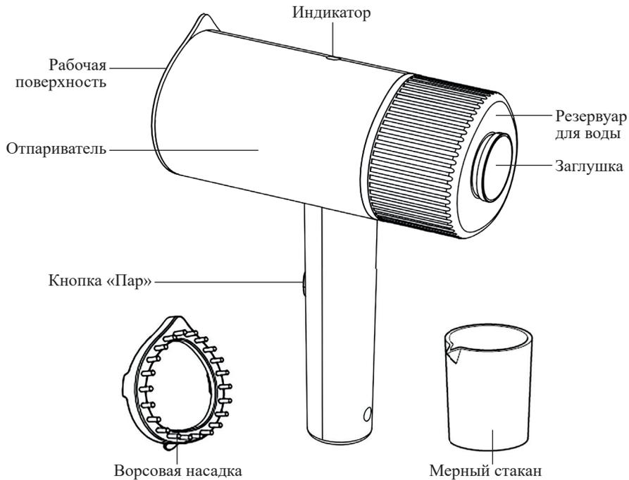
Отпариватель оснащен помпой (водяным насосом). Вода из резервуара подкачивается помпой и по шлангу передается к бойлеру, где испаряется. Пар выходит через паровые сопла на рабочей поверхности. Помпа позволяет точно дозировать количество подаваемой в бойлер воды и получать устойчивую подачу пара.
